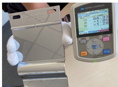
SurTec 883 XT liefert einen identischen Farbton zu klassischen Chromschichten, sowohl visuell als auch mittels Farbmessung gemäß L*a*b*-Skala
