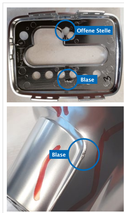
Abb. 1: Fehlerbilder im Anlieferzustand bei 1K-Teilen
