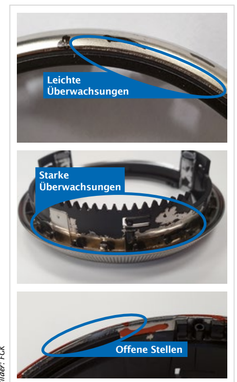
Abb. 2: Fehlerbilder im Anlieferzustand an Mehrkomponententeilen
