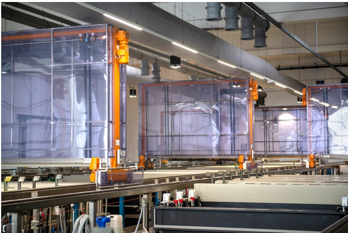
Abbildung 1: 3-wertige Verchromung bei KTB
